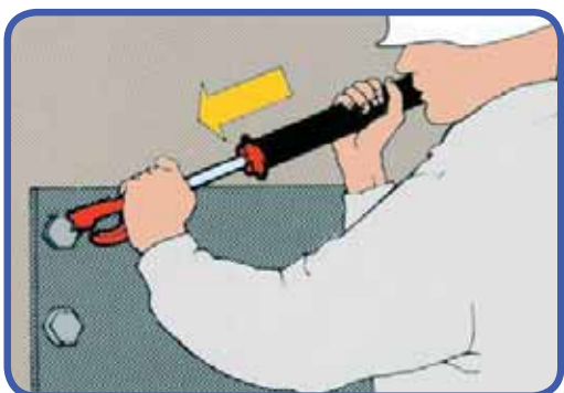
3. Stöta loss - skruva ur - muttrar och skruvar.
