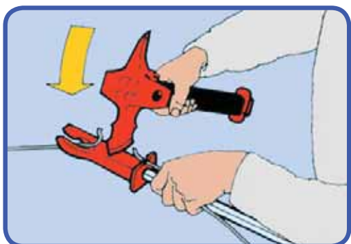
5. Wire, tågvirke, kablar o. d., korta slag - stöd stängan mot armen.
