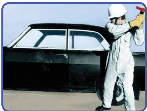
1. Slå ur spänningarna. Använd yxdelens kupade sida.
