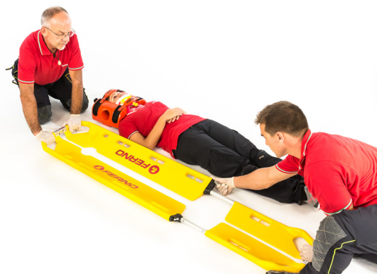
Fig. 16 - Justering av bårens längd
